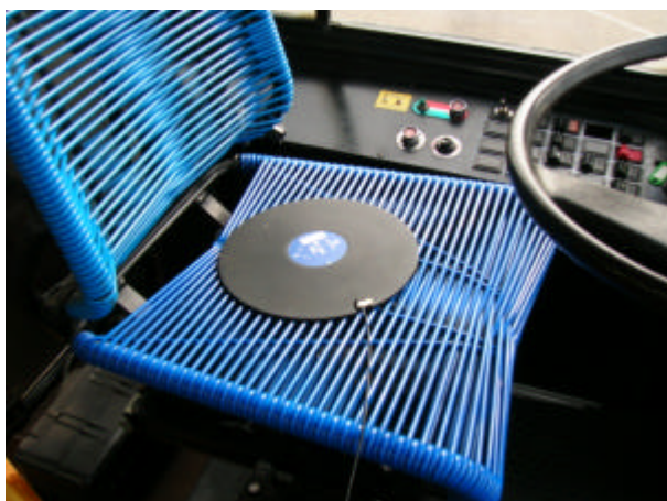
In foto: Accelerometro per rilevazione delle vibrazioni trasmesse al corpo intero.
